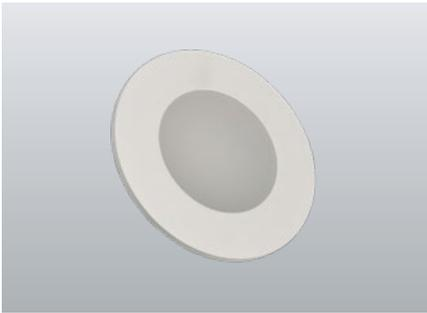
Hochwertige LED- Sicherheitsleuchten mit homogenem Lichtaustritt zur Ausleuchtung von Flächen und Rettungswegen. Leuchten für Deckeneinbaumontage mit pulverbeschichtetem Aluminiumgehäuse. Werkzeuglose Montage in Ø 68mm Deckenausschnitt ohne sichtbare Schrauben.
