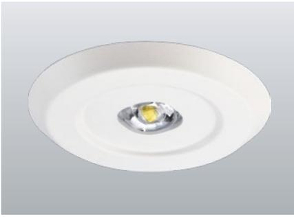
LED-Sicherheitsleuchte mit optimierter Lichtverteilung zur Ausleuchtung von Flächen. Leuchten für Deckeneinbaumontage mit pulverbeschichteter Aluminiumblende ohne sichtbare Schrauben. Zum Einbau in Ø 68mm Schalterdose. Inkl. 4-Chip LED-Leuchtmittel für maximale Sicherheit.
