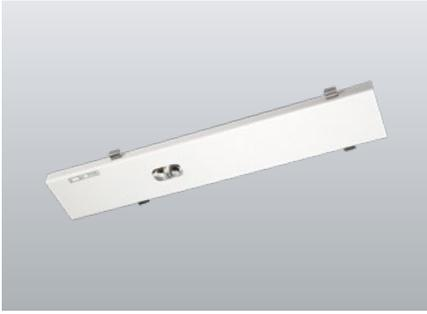
LED-Sicherheitsleuchte mit optimierter Lichtverteilung zur Ausleuchtung von Rettungswegen mit großen Lichtpunkthöhen. LED-Geräteträger für Trilux E-Line Lichtbandsystem 7650...7LV + 5LV mit werkzeuglos zu betätigenden Edelstahl-Rastverschlüssen. Selbsttätige elektrische Verbindung durch Steckkontakte mit Stromkreisauswahl. Inkl. 4-Chip LED-Leuchtmittel für maximale Sicherheit.
