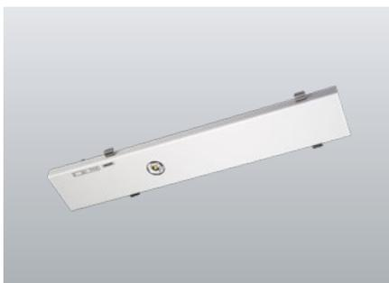
LED-Sicherheitsleuchte mit optimierter Lichtverteilung zur Ausleuchtung von Flächen mit großen Lichtpunkthöhen. LED-Geräteträger für Trilux E-Line Lichtbandsystem 7650...7LV + 5LV mit werkzeuglos zu betätigenden Edelstahl-Rastverschlüssen. Selbsttätige elektrische Verbindung durch Steckkontakte mit Stromkreiswahl. Inkl. 4-Chip LED-Leuchtmittel für maximale Sicherheit.
