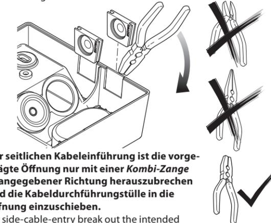
**Zur seitlichen Kabeleinführung ist die vorgeprägte Öffnung nur mit einer Kombi-Zange in angegebener Richtung herauszubrechen und die Kabeldurchführungsstülpe in die Öffnung einzuschieben.**
