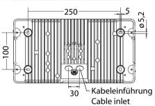
Kabeleinführung 20mm. Beiliegende Membrantüllen verwenden. Membrantüllen für Leitungsdurchmesser von 6,0mm bis 13,0mm. Alternativ Kabelverschraubungen mit Dichtring verwenden. INOTEC-Zubehör: 104661784 (2 x M20 Kabelverschraubung mit Gegenring).
