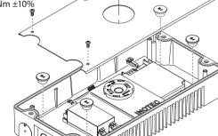
Um die Schutzart IP65 zu gewährleisten, sind alle 4 Verschlussstopfen unbedingt zu montieren.
