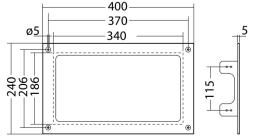
Deckenausschnitt/ Ceiling cut-out Einbautiefe/Mounting Depth 340x186mm min. 100mm
